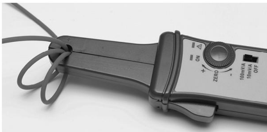
图 4：PT710-D 提高电流灵敏度方式
